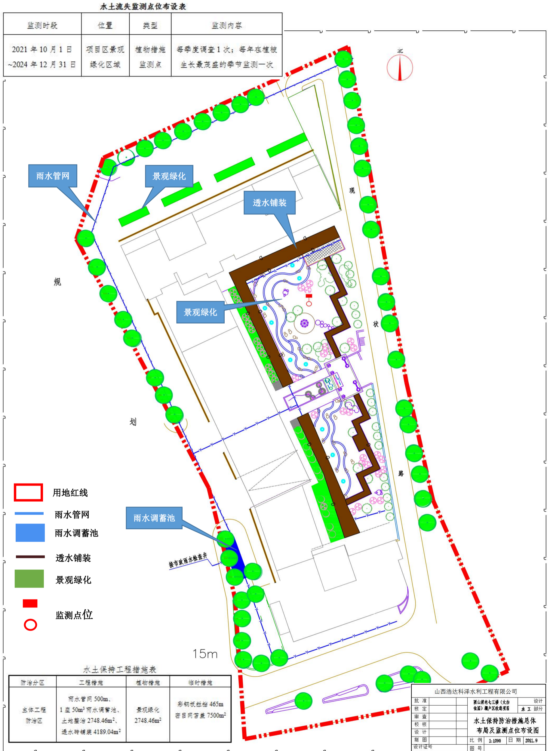
附图五 水土流失防治措施总体布局及监测点位
