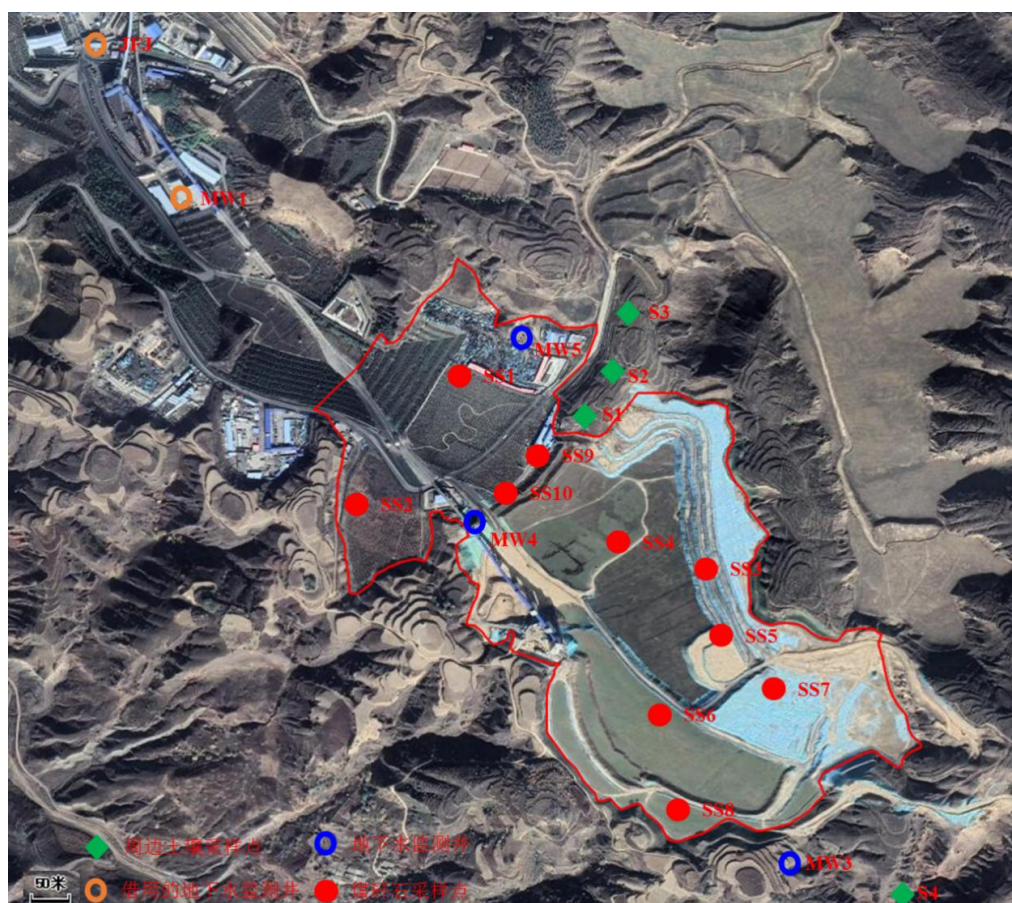
图 5.1.4-1 地块勘探孔平面布置图
